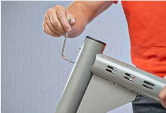
Revissez les vis démontées auparavant dans la colonne.
