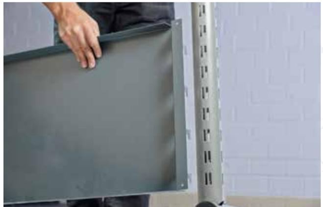
Placez 2 colonnes terminées à une distance de 1,25 m l'une de l'autre. Joignez les crochets de la paroi arrière métallique 40 cm 3381010185 aux deux colonnes.
