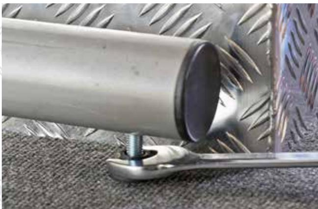
Ajustez la hauteur des vis de réglage afin que le module soit stable.
